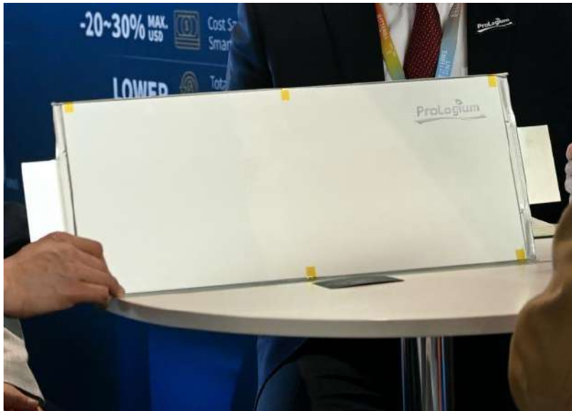
Ce type d'élément permet de confectionner les modules qui, assemblés, composent les batteries. Photo Jean-Louis Burnod
